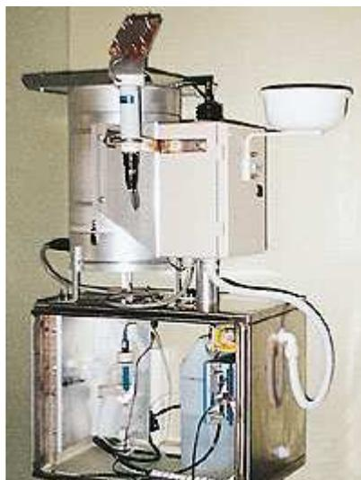
All'inizio di ogni precipitazione il sensore di presenza pioggia comanda il movimento del coperchio dalla bocca bagnato a quella secco.
